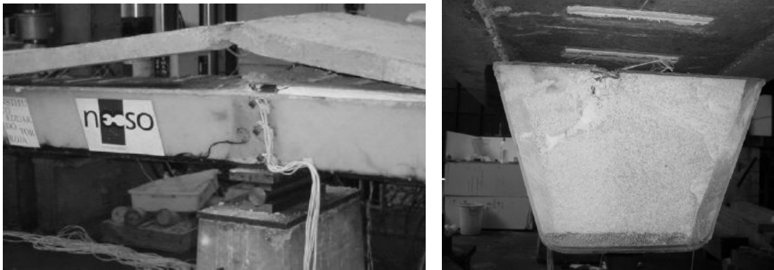
Figura 10: Fallo de la probeta de fibra de vidrio sobre el apoyo central con rotura de los conectores
